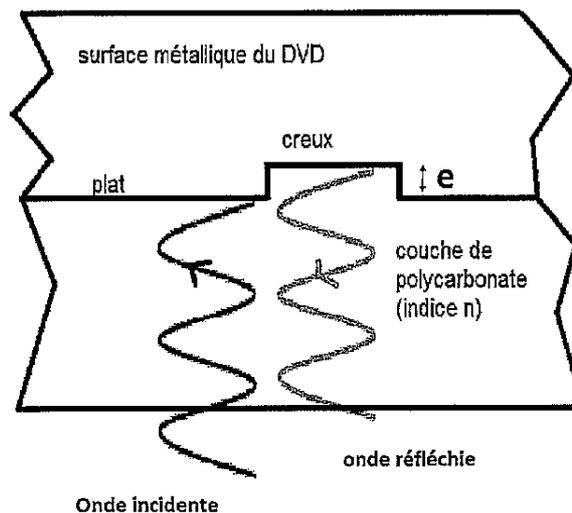
Quelle est la profondeur e du creux d'un disque DVD ?
